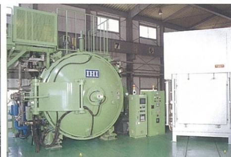
▲真空焼入炉(左)と焼戻炉
